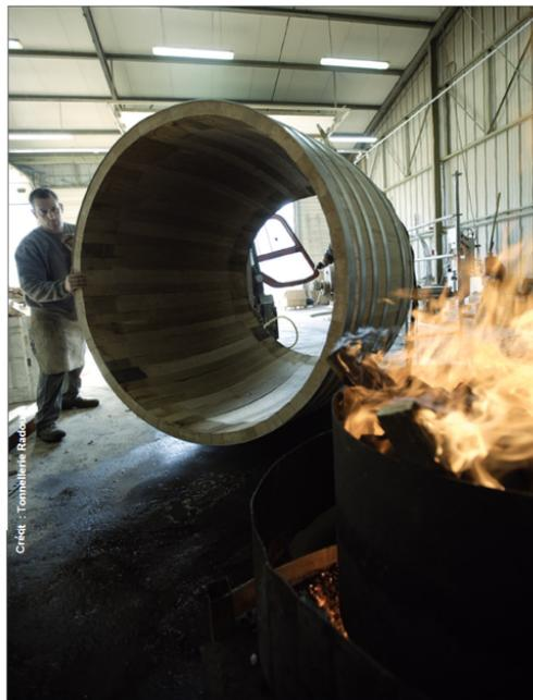
Foudrier d'origine, la tonnellerie de Jonzac a mené des travaux sur l'évolution des températures à l'intérieur du fût. Cela permet de proposer des chauffeuses qualifiées et reproductibles.
